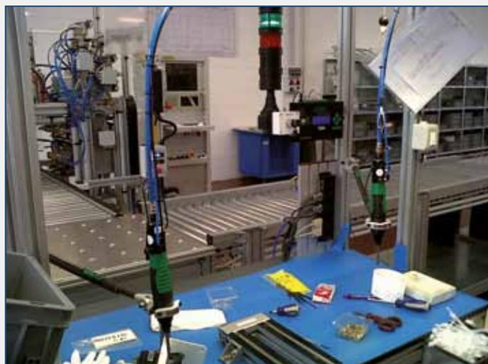
Nella configurazione sopra illustrata, il semaforo evidenzia all'operatore lo stato delle sequenze di avvitatura: OK - NOK e FINE CICLO. Il **dispositivo opzionale con chiave** invece, permette al capo linea di sbloccare il ciclo di avvitatura: in caso di 2 errori sullo stesso componente, il ciclo infatti si blocca e il pezzo viene scartato.
